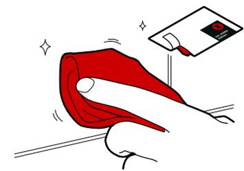
Verwenden Sie anschließend das beiliegende Vorbehandlungstuch zur Endreinigung der Oberfläche.
