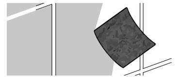
Entfernen Sie groben Schmutz wie Kalk, Zementschleier etc. mit beiliegendem Schleifvlies und geeignetem Reiniger.
