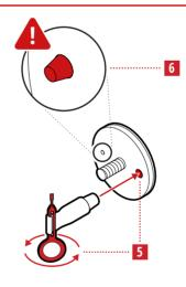
Klebstoff einfüllen Insert glue
