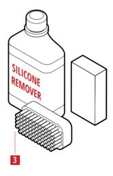
Oberfläche reinigen Clean surface
