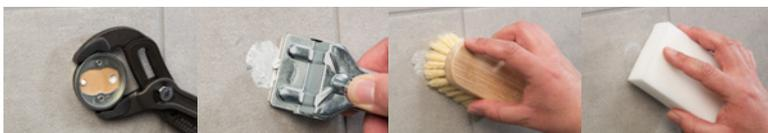
1. Adapter mit Zange abdrehen 2. Haftmittlrückstände mit Glasschaber, Bürste oder Radierschwamm beseitigen.
