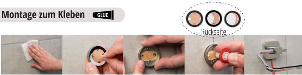
1. Untergrund reinigen 2. Schutzfolie des Adapters abziehen 3. Adapter an der Wand vorfixieren 4. Klebstoff einfüllen 5. Accessoire mittels Multitool montieren, nach 6 Stunden ist das Accessoire voll belastbar.
